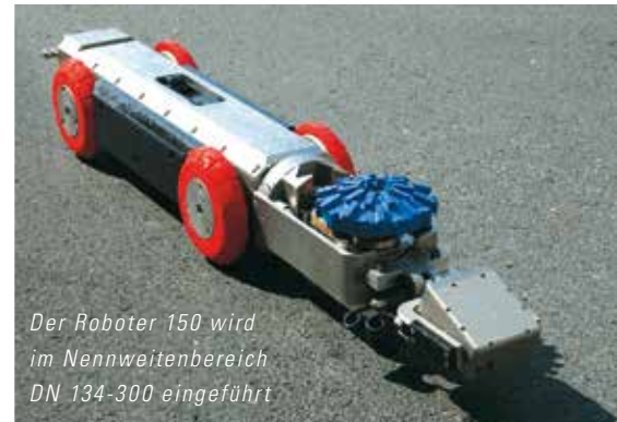
vom Steuerpult aus werden die Roboter im Kanal ferngesteuert
