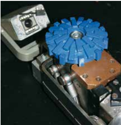
Fräsroboter DN 150 mit Schwenkkopfkamera
