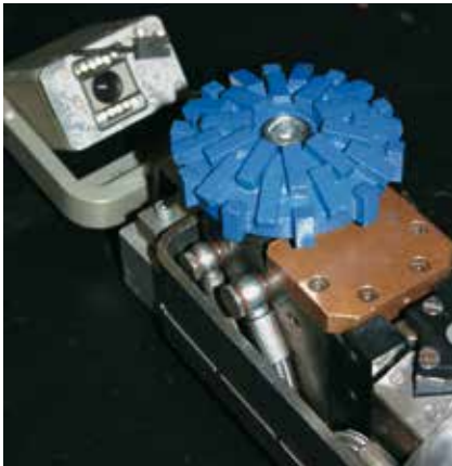
Fräsroboter DN 150 mit Schwenkkopfkamera
